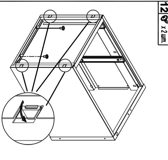
\* - В нижней части корпуса картотеки (на рис. не показано) так же устанавливаются 2 самореза.
